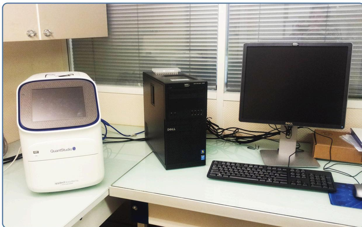
Le Q-PCR est un appareil capable de suivre une réaction enzymatique, celle de l'enzyme ADN-polymérase en temps réel, c'est-à-dire pendant qu'elle travaille.
